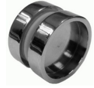
1167-CRO Tirador redondo. Vidrio 8/10mm Taladro: Ø 12mm Total: Ø 38mm Grueso: 11mm cada lado Acabados: Cromo brillo (CRO)
