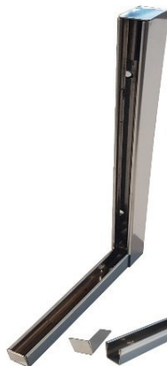
0616-INOX 0616-MAT U de acero plegado canto vivo TALADRADO Medidas: 15X15X15X1mm Vidrio: 8-10-12mm Barras: 3m Acabado: Inox Brillo y Inox mate
